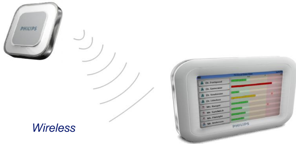
Abbildung 9: Strahlendosis Übertragung von PDM auf ein im Herzkatheterlabor befindlichen Monitor(Basis Station)
