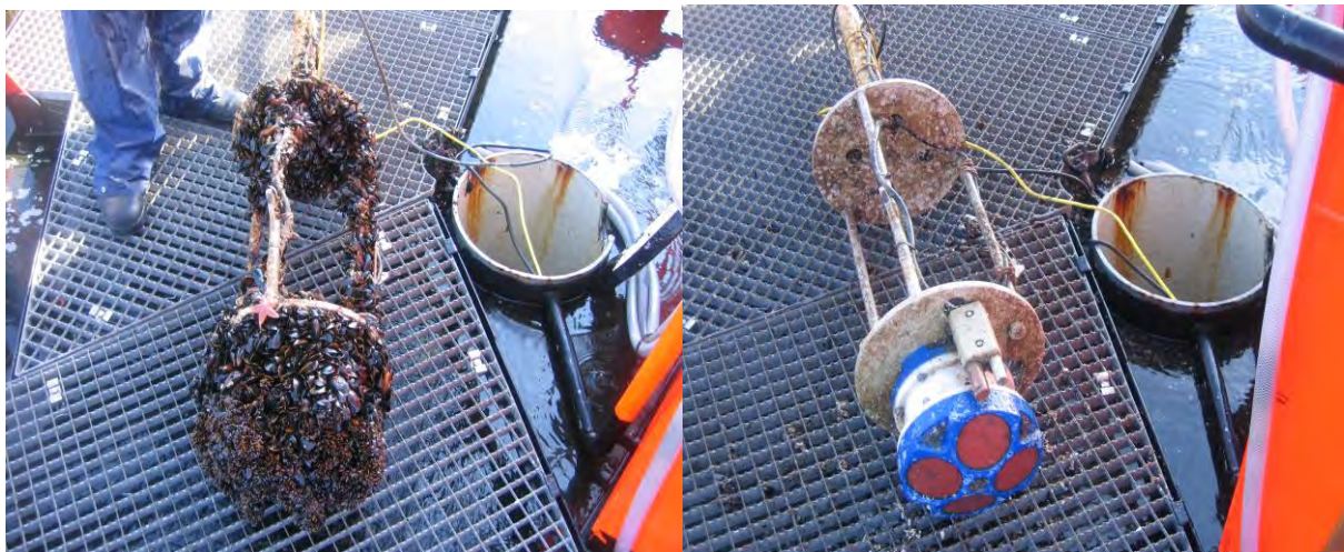
Abb. 50: Akustischer Strömungsmesser auf der Station Fehmarnbelt vor und nach der Reinigung, (Autor)
