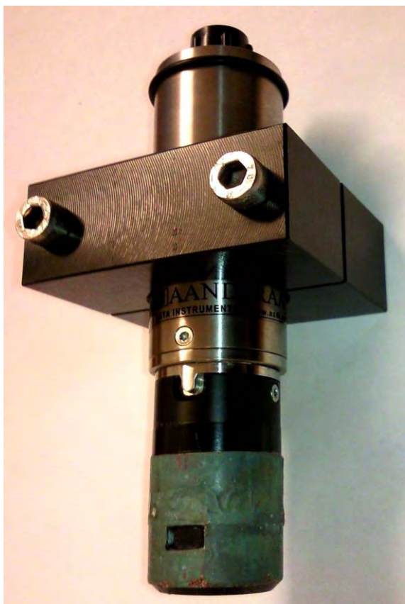
Abb. 47: Sauerstoffoptode mit Halterung und kupfernem Biofouling-Schutz, (Autor)
