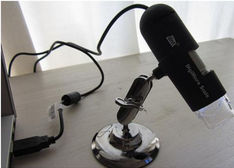
Abb. 9 USB-Auflichtmikroskop DigiMicro2.0 ® von dnt (eigene Aufnahme)
