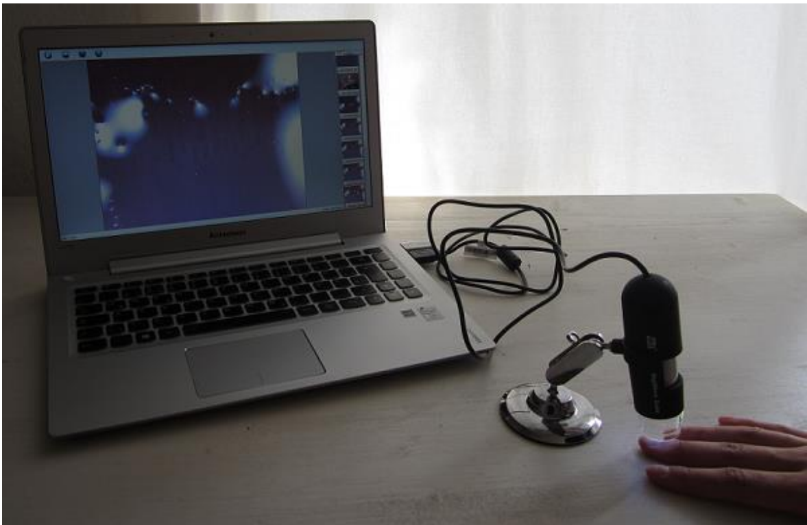
Abb.10 USB-Auflichtmikroskop DigiMicro2.0 ® von dnt mit Anschluss an den PC zur Kapillarmikroskopie (eigene Aufnahme)
