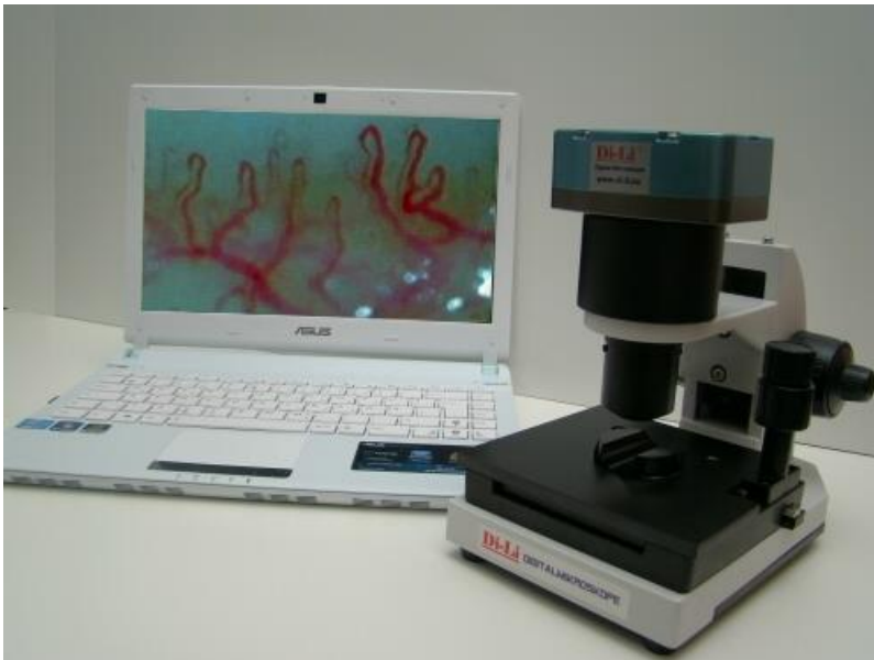
Abb. 12 Di-Li 2056 Auflicht-Digital-Zoom-Mikroskop® von Micron mit Anschluss an den PC (Quelle: http://www.di-li.eu/kapillarmikroskop-usb-laptop-kn.JPG )
