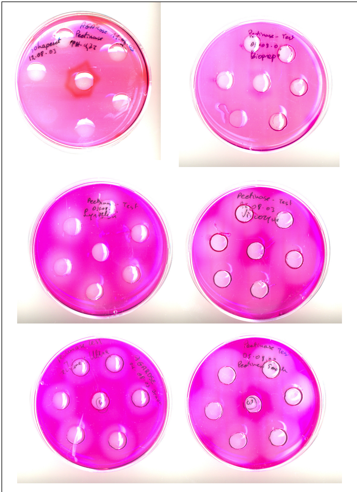
Abb. 27: Plattengelschnelltest zum Nachweis der Pectinase-Enzymaktivitäten von Rohapect, Bioprep, Viscozym, Lyvelin, Pectinex Smash und Pectinex Ultra. Der Abbau zeigt sich durch helle Abbauhöfe des Pectinsubstrates, die Kontrolle (Aqua demin.) im Plattenzentrum zeigt keine Entfärbung des mit Rutheniumrot gefärbten Substrates.
