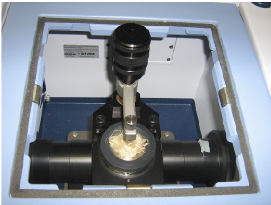
Abb. 10: Fasermessung im FTIR. Auf den Messtisch wird ein Faserknäuel oder eine vorher zu präparierende Substrattablette verbracht und gemessen. Das Einbringen der Fasern in die Messzelle ist einfach und schnell durchzuführen (eigene Aufnahme 2010).
