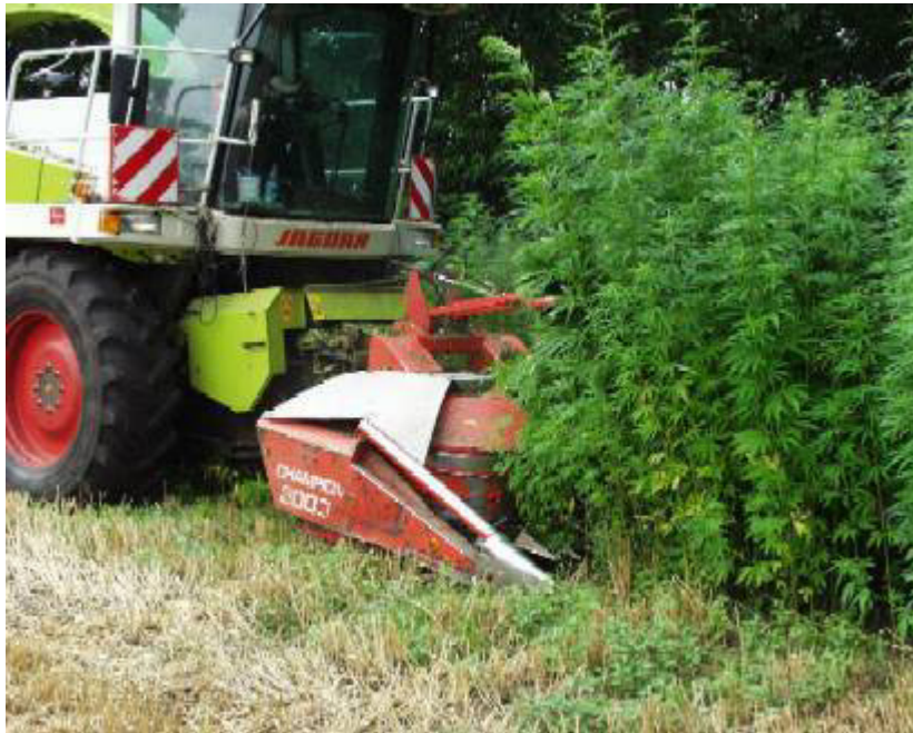
Abb. 2: Claas Jaguar Selbstfahrhäcksler und reihenunabhängiger Mähvorsatz Kemper Champion 3000 mit einer für die Hanfernte angepassten Schneidvorrichtung. Die Aufnahme entstand bei der Ernte der Sorte Felina 34 der Fa. AGRO-Dienst in der Nähe von Huntlosen, Niedersachsen (eigene Aufnahme 2002).
