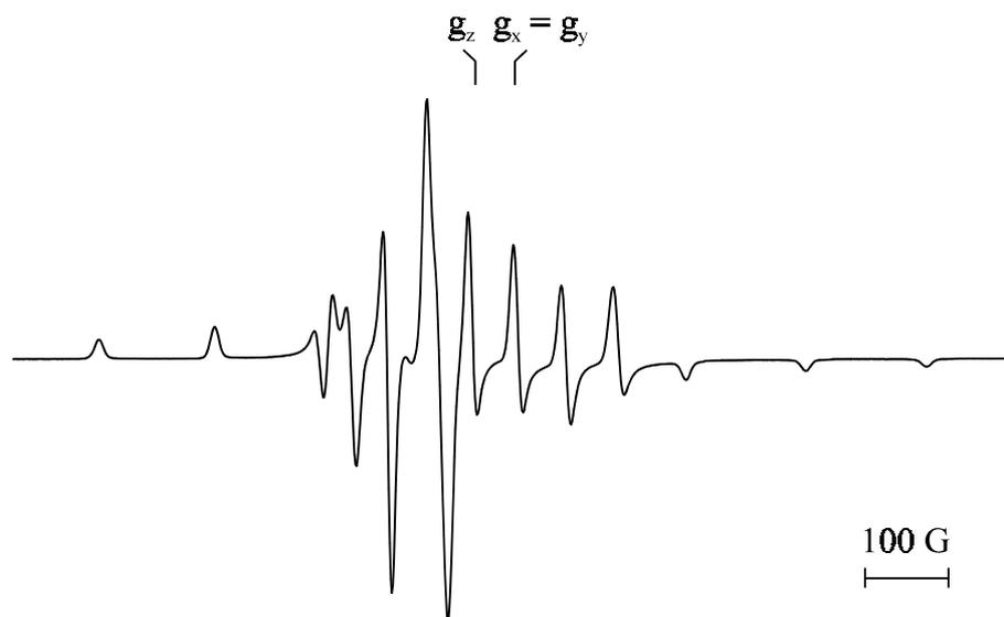
**Abb. 7:** ESR-Spektrum von  $[\text{V}(\text{L-N}_4\text{Me}_2)(\text{MeCN})\text{O}](\text{ClO}_4)_2$  in gefrorener Lösung (0.2 M TBAP/MeCN) bei 110 K
