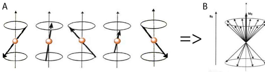
**Abbildung 2.5: Netto-Magnet-Vektor:** A: Einzelprotonenspins, B: Summe der Einzelprotonenspins. Transversale Komponenten heben sich in der Summe auf, longitudinale ergeben einen positiven Netto-Magnet-Vektor  $M_0$  (modifiziert aus Siedentopf (2001)).
