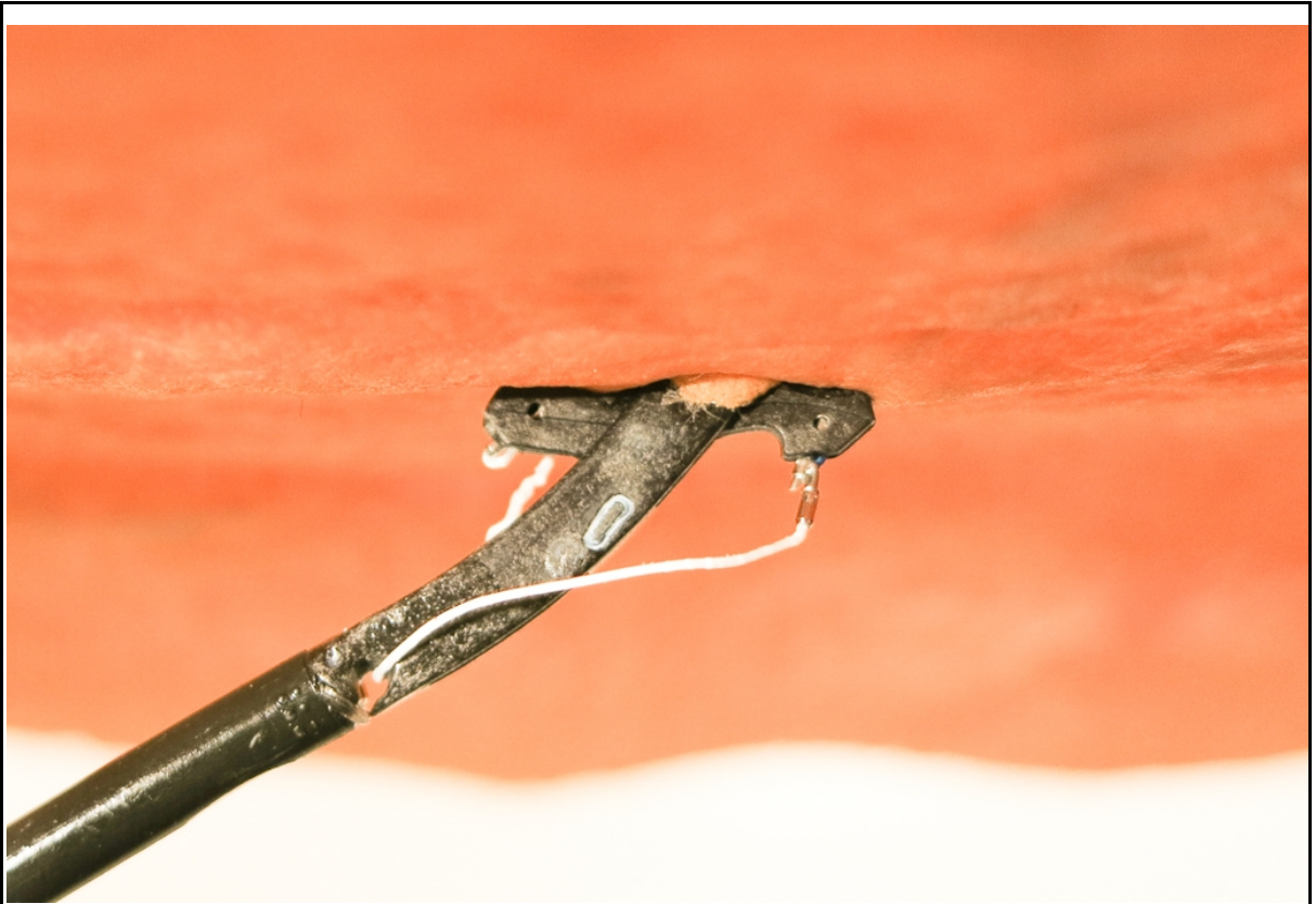
Abbildung III: Nadeln nehmen den Faden auf (Punkt 4b)*
