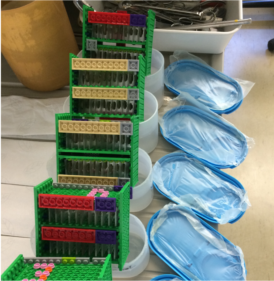
Abbildung 3: Objektträger mit den Zahnschmelzproben in den für den Versuch gebauten Lego-Objekthaltern
