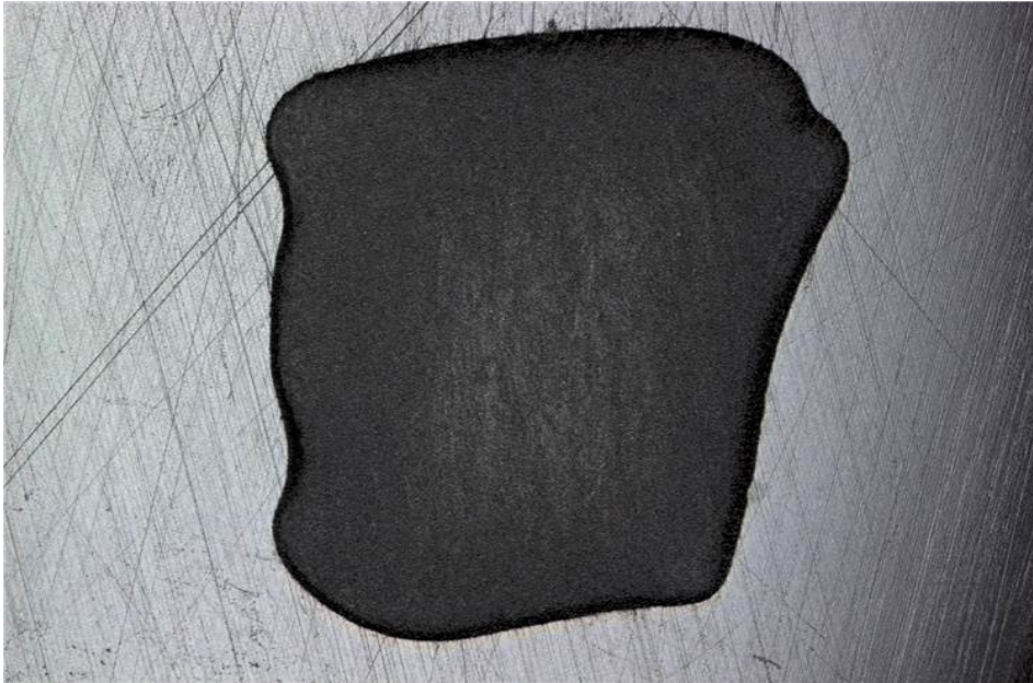
Abbildung 5: Zahnprobe vor dem Ausmessen des Zahnhartsubstanzabtrages (aufgenommen mit dem LSM): Die heller erscheinende Referenzfläche und die dunkle Versuchsfläche sind deutlich zu erkennen.
