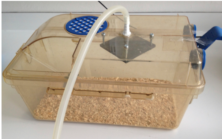
Abb. 11: Für Begasung modifizierter IVC-Käfigdeckel.
