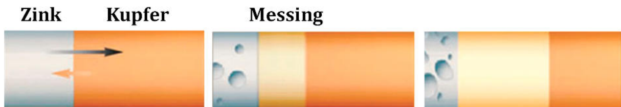
Abbildung 39: Skizzierte Darstellung des Kirkendall Effekts anhand der Bildung einer Messinglegierung aus Kupfer und Zink. Aufgrund der unterschiedlichen Diffusionsgeschwindigkeiten wächst die Legierung in Richtung des Kupfers es entstehen Löcher in der Zinkphase.
