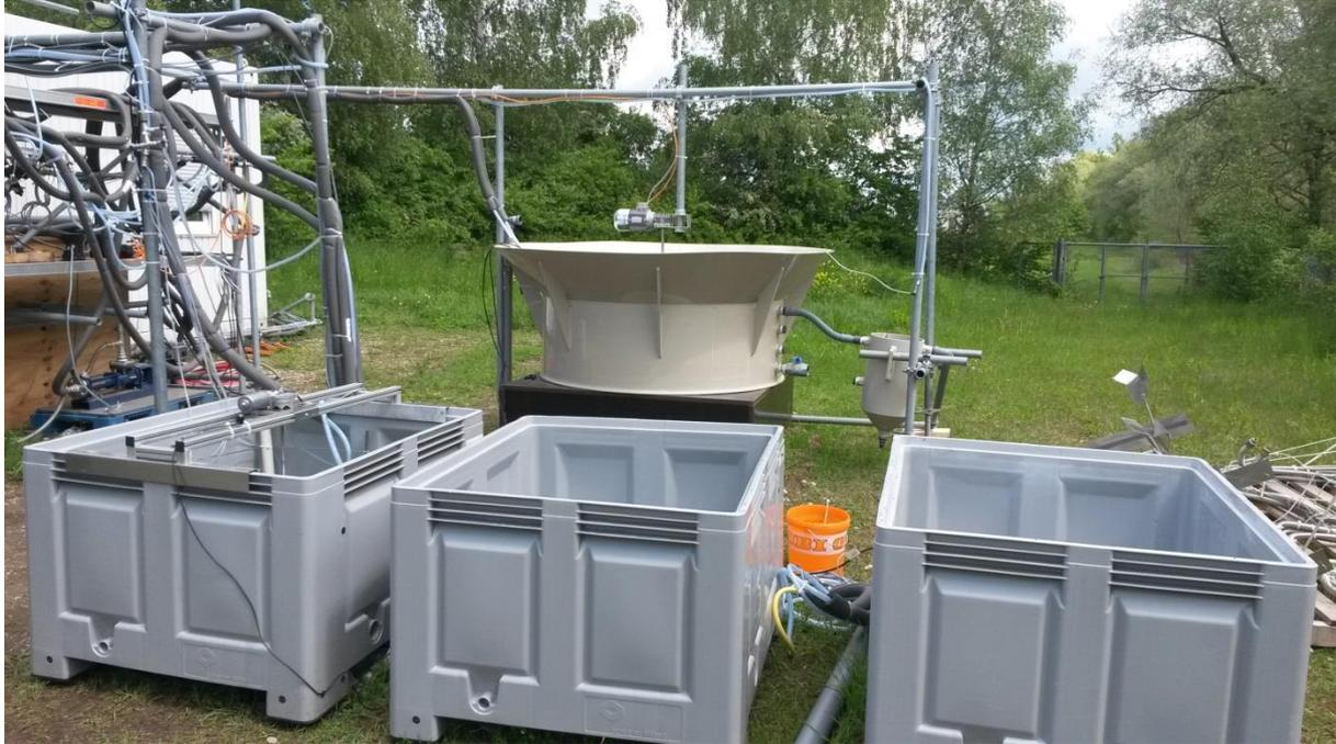
**Abb. 3:** Versuchsaufbau der Pilotanlage zur Reinigung von Papierfabrikabwasser mittels Mikroalgen-Bakterien-Flocken. Aufnahmen zeigen 3 offene rechteckige Kultivierungsbecken und den 800 L Reaktor.
