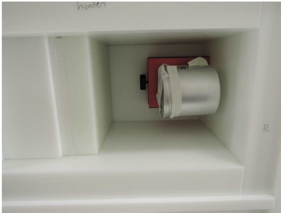
Abbildung A.5 – Photographie des offenen Polyethylenkastens (außen und unten) aus der Vogelperspektive mit Spaltmaterial auf Probenhalter (rechts), zusätzlichen 5 cm + 1 cm + 1 cm = 7 cm Polyethylen (mittig) und der Neutronenquelle in der Polyethylen-Halterung. Photographiert von Ludwig Holzleitner, JRC-KRU.
