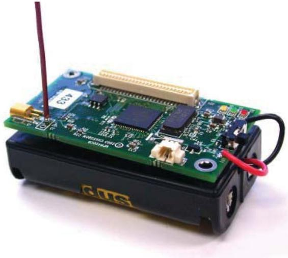
Abbildung 4.1.: Sensorknoten eines drahtlosen Sensornetzwerks<sup>1</sup>
