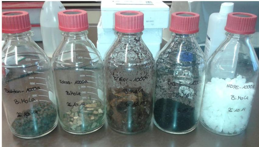
**Abbildung 3-1:** Dargestellt sind die fünf Materialien (von links nach rechts: Blähtonbruch, Kokoschale, Kiefernrinde, Bio-Kohle und HDPE-Carrier) in den Batch-Gefäßen (1-L-Schottflaschen, gasdicht verschlossen mit Gummistopfen und Lochkappe).
