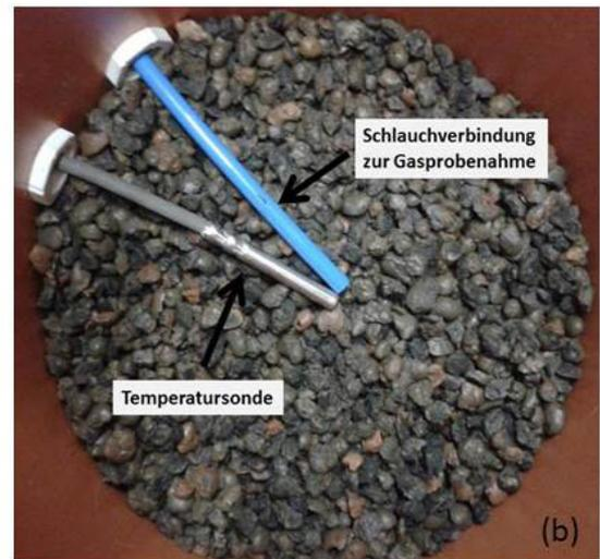
Abbildung 3-3: Aufbau des Säulenversuchs, nicht im Bild sind die Wassersäulen. (a) Gesamtansicht des Versuchsaufbaus; (b) Lage der Schlauchverbindung (blauer Schlauch) in jeweils fünf Tiefen und der Temperatursensoren in jeweils drei Tiefen im Biofiltermaterial mittig in den Säulen.
