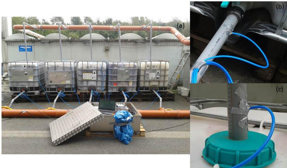
**Abbildung 3-8: Aufbau der 24 stündigen Messkampagne zur kontinuierlichen Bestimmung der Roh- und Reingaskonzentrationen von Methan und Kohlendioxid. (a) Gesamtansicht des Aufbaus mit den fünf IBCs und dem Messsystem bestehend aus Ultra-Portable Greenhouse Gas Analyzer und Multiplexer im Vordergrund. Aufbau für den Versuchsbiofilter (nicht abgebildet) identisch. (b) Gasprobenahmestelle des Reingases; (c) Gasprobenahmestelle des Rohgases.**
