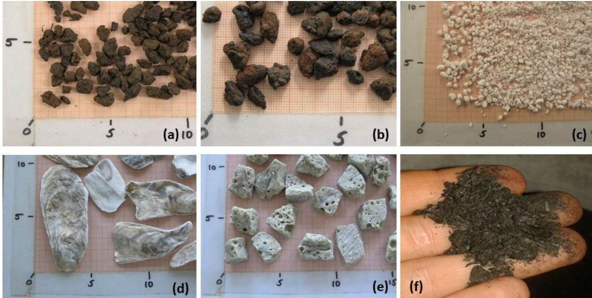
**Abbildung 4-3: Anorganische, naturnahe Biofiltermaterialien. (a) Lavabruch, (b) Blähtonbruch, (c) Perlit, (d) Austernschalen, (e) Glafoam, (f) Biokohle.**
