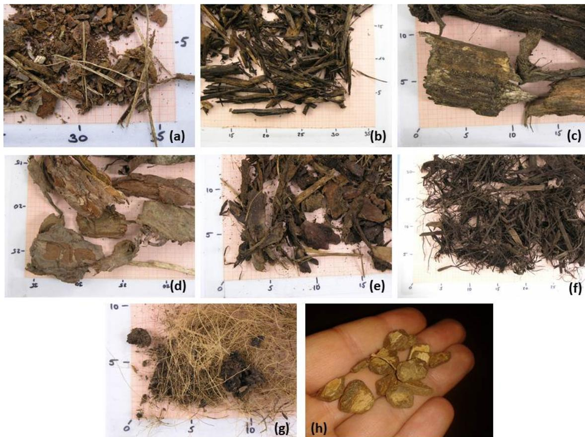
**Abbildung 4-1:** Ausgewählte „neue“ organische Biofiltermaterialien; (a) Rindenholzhäcksel, (b) Wurzelholzhäcksel, (c) Wurzelholz, (d) und (e) Kiefernrinde, (f) Xylit, (g) Kokosfaser-Torf-Mix, (h) gehäckselte Kokoschale (ohne Fasern).
