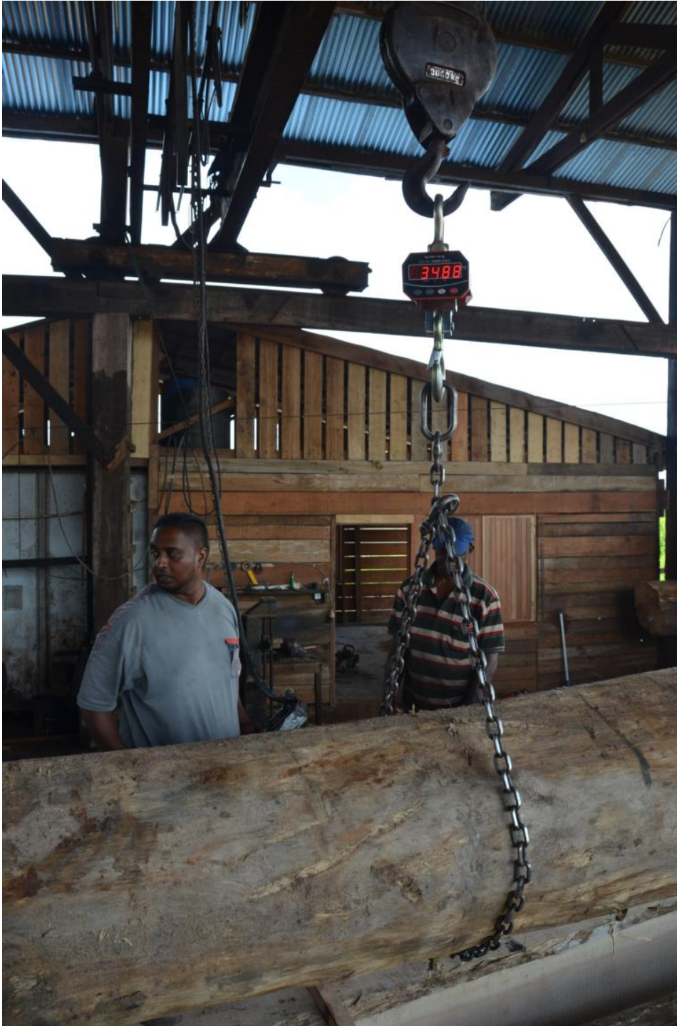
Abbildung 7.1.: Ausbeutemessung mit Kranwaage während des Betriebsablaufs
