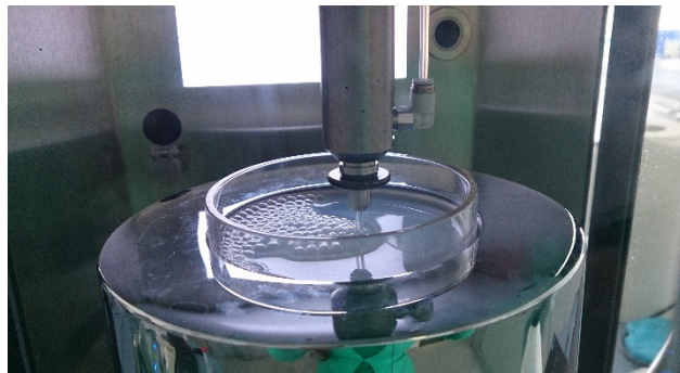
Abbildung 20: Bestimmung der dynamischen Oberflächenspannung der Latexdispersion mittels Blasendruck-Tensiometer
