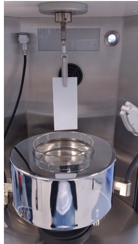
Abbildung 24: Tensiometrische Bestimmung der Benetzbarkeit einer Prüfoberfläche (PTFE) mit der Latexdispersion
