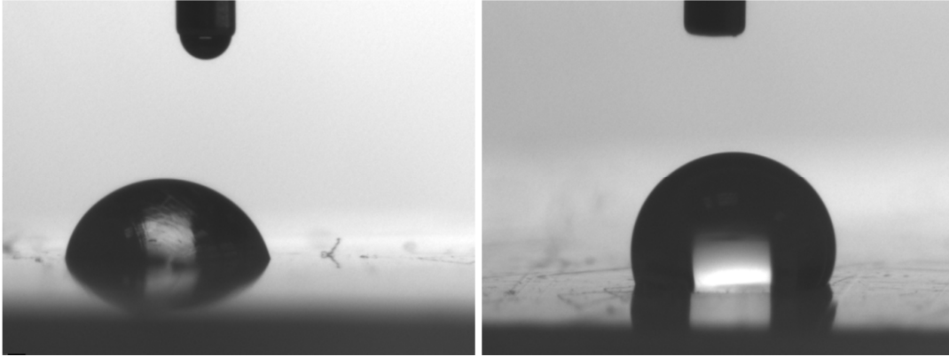
Abbildung 29: Dosierte Tropfen von Wasser (rechts) und Diiodmethan (links) auf PTFE für die Bestimmung der freien Oberflächenenergie durch die Methode des liegenden Tropfens.
