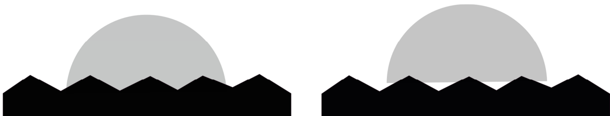
Abbildung 14: (links): Wenzel-Zustand: Der dosierte Tropfen dringt in die Rauheit der Oberfläche ein. Es liegt eine homogene Benetzung vor. (rechts): Cassie-Baxter-Zustand: der Tropfen ist auf den Spitzen der Rauheit positioniert. Es sind Kontaktflächen mit der Oberfläche und mit der Luft vorhanden. Es liegt eine heterogene Benetzung vor [114].
