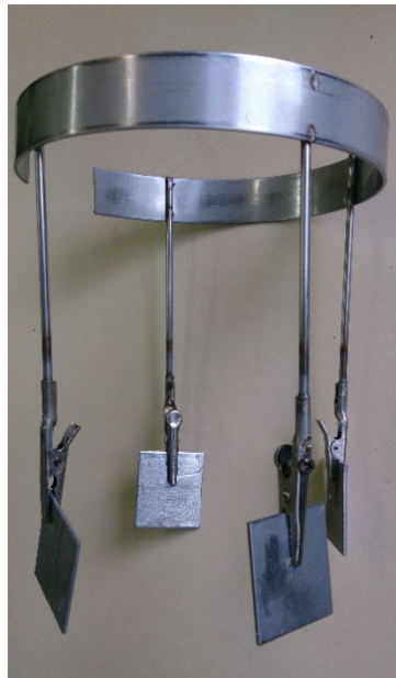
Abbildung 27: Haltering zum Einspannen der Prüfoberflächen in den Reaktor und Prüfoberflächen, die mittels Krokodilklammern am Haltering fixiert werden
