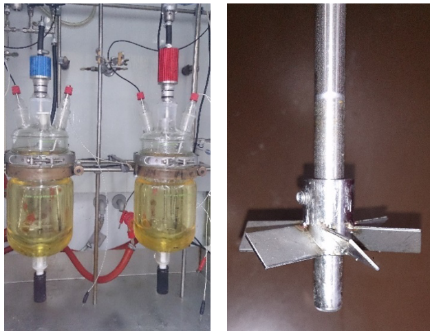
Abbildung 25: Die verwendeten chemischen Batch-Reaktoren zur Emulsionspolymerisation (links) und der eingesetzte Schrägblattrührer (rechts)
