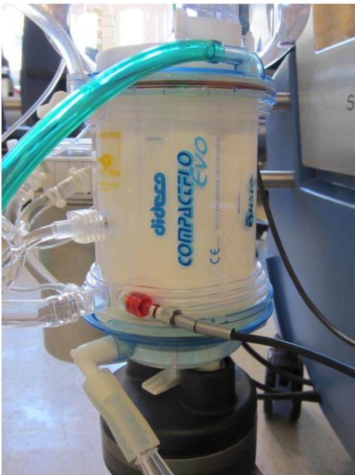
Abb. 4. Membranoxygenator der HLM. Membranoxygenator Compactflo Evolution® (Sorin Group, Mailand, Italien) mit einer Membran aus PPL.
