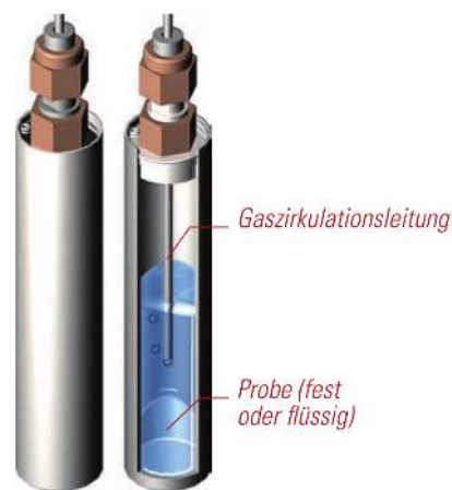
Abbildung 3.7 Aufbau der Gasdurchflusszelle zur Untersuchung von Hydratationsreaktionen. Bild verwendet mit freundlicher Erlaubnis der Firma Setaram Instruments
