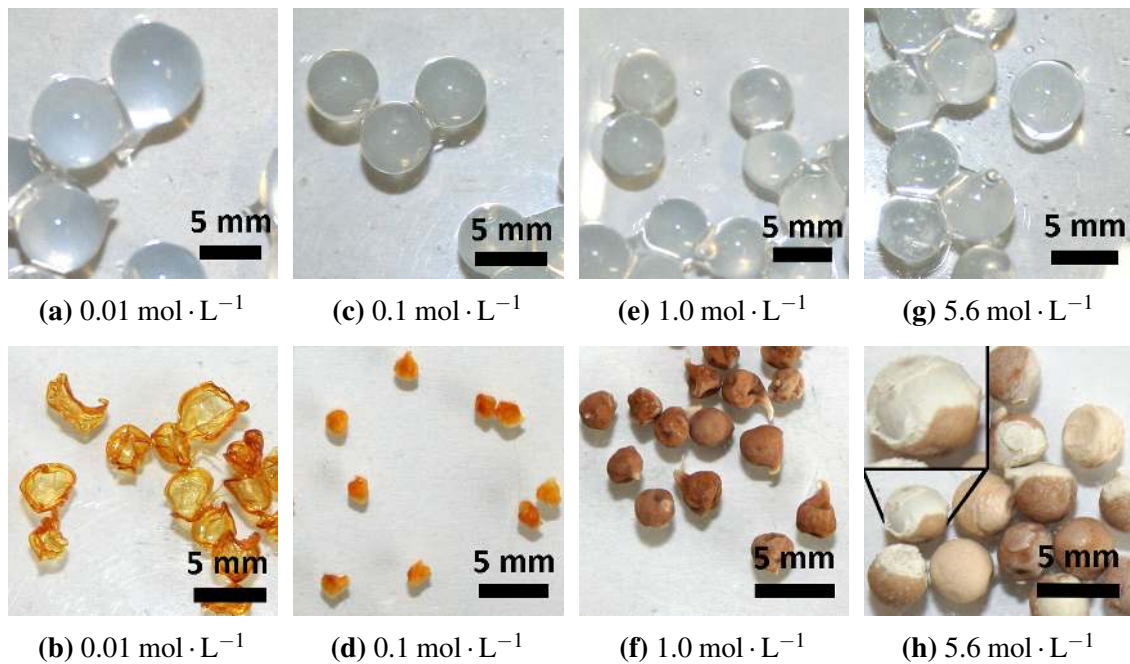
Abbildung 5.43 Fotos der Hydrogelkugeln und der daraus resultierenden getrockneten Komposite in Abhängigkeit von der Konzentration der SrCl 2 -Geliertsalzlösung. (a), (c), (e) und (g) stellen die gebildeten Hydrogele dar, (b), (d), (f) und (h) die aus der Trocknung bei 140 °C resultierenden Komposite.
