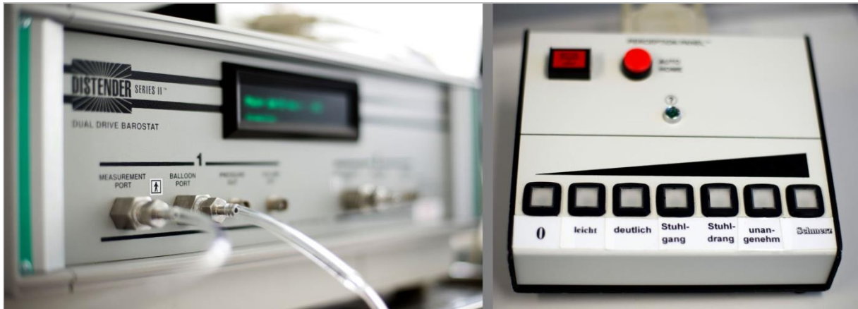
Abb. 3: Barostatgerät (Typ DISTENDER SERIES II™ G&J Electronics Inc.) und Tastatur zur synchronisierten Erfassung der Wahrnehmungsqualitäten
