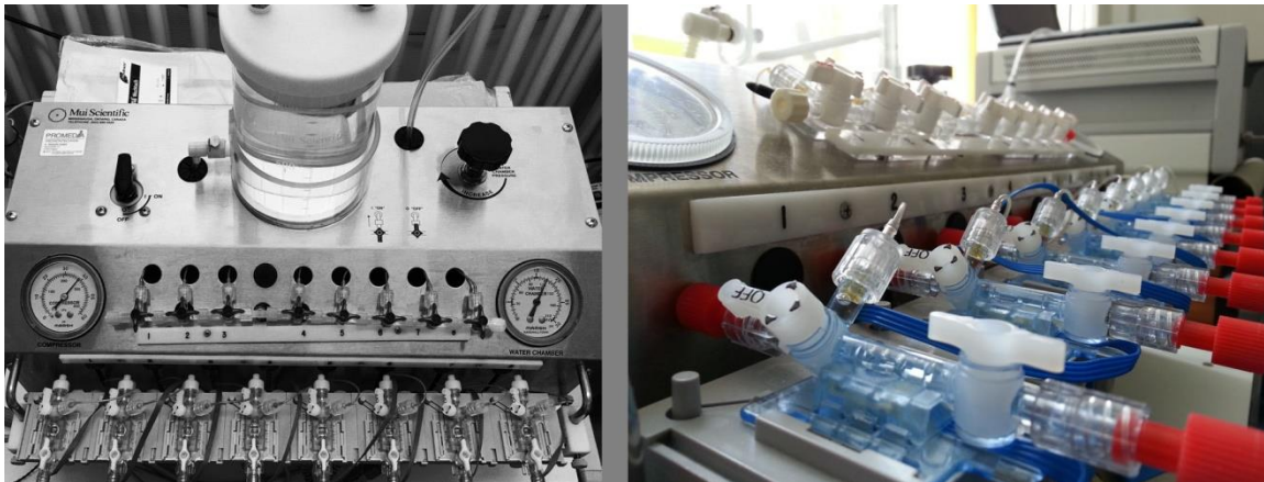
Abb. 8: Wasserperfusions-Manometriegerät (Mui Scientific, Model Nr. PIP-4-8)
