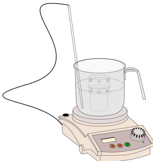
Abbildung 16: Reaktionsaufbau der inversen Vulkanisation im kleinen Druckreaktor.
