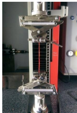
Abbildung 126: Fotografische Abbildung eines Zug-Dehnungs-Experiments mit der Materialprüfmaschine von ZWICK / ROELL.
