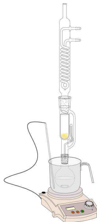
Abbildung 26: Schematischer Aufbau der Soxhletapparatur zur Extraktion der Vernetzermomere.
