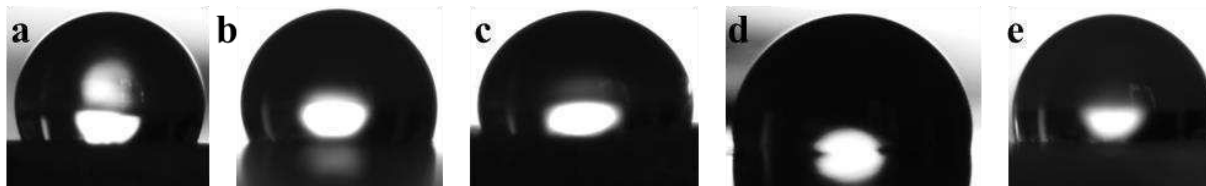
Abbildung 136: Abbildung eines Wassertropfens auf der Oberfläche eines Schwefelcopolymeren für die Bestimmung des Kontaktwinkels. (a: 15 % DVB, b: 25 % DVB, c: 20 % DVB-STY (15:5), d: 30 % DIB, e: Elementarer Schwefel).
