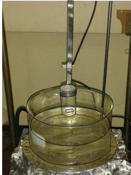
Abbildung 14: Reaktionsaufbau der inversen Vulkanisation im Glas-Vial.
