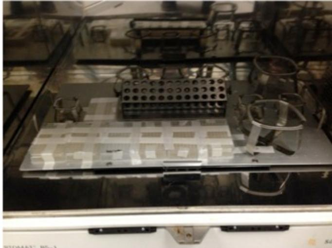
**Abbildung 11: Versuchsanordnung zur parallelen Inkubation mehrere Deepwellplatte.** Dargestellt ist ein Foto der auf einer Motorplatte eines Schüttelinkubators mit Pflasterstreifen fixierten Deepwellplatten.
