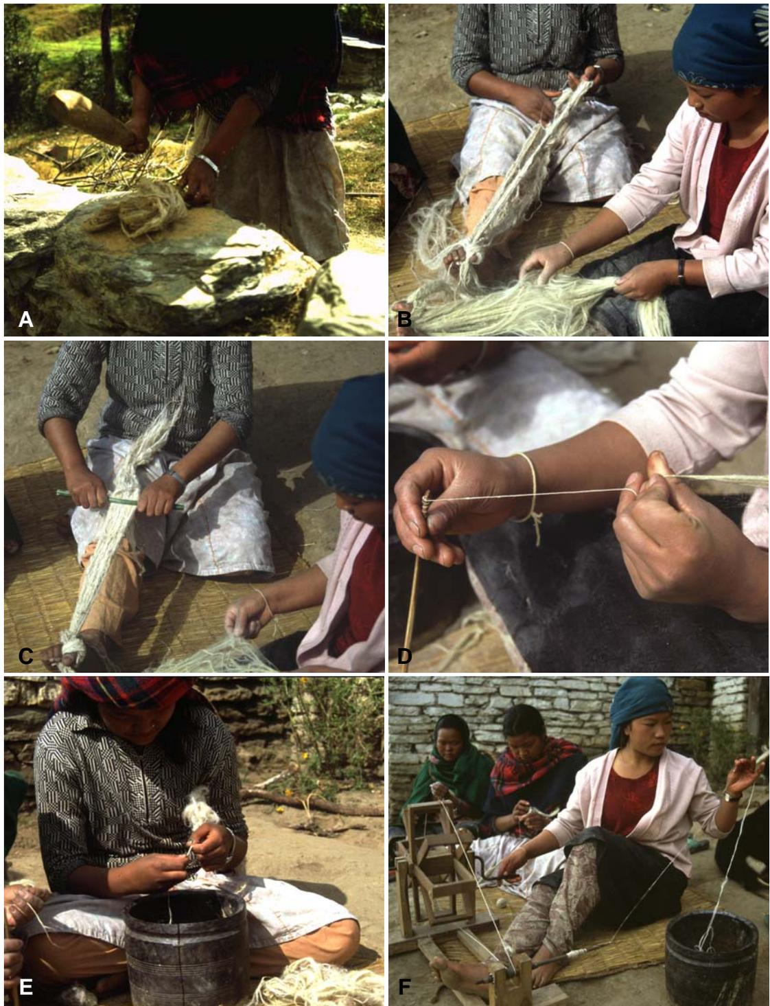
**Abb. 3:** Fasergewinnung in Saliza - Fortsetzung. (A) Ausklopfen der Reisspelzen, (B) Verstrecken der Faserbündel, (C) Parallelisieren der Fasern, (D) Spinnen mit der Handspindel, (E) Herstellung eines Vorgarns, (F) Spinnen des Vorgarns mit dem Spinnrad.
