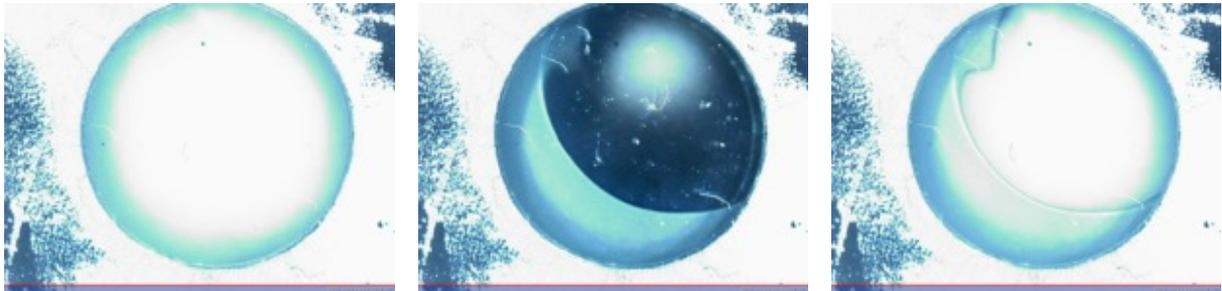
Abbildung 4.11 Beobachtung einer Zelle mit einer Elektrode aus reinem ITO. Dieses wurde mittels Sputterbeschichtung auf ein Glassubstrat aufgebracht. Der Farbumschlag ist deutlich erkennbar und war reversibel und spannungsabhängig. Daten aus Versuch MR29Z1P04.
