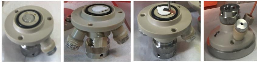
Abbildung 3.4 Zusammenbau der Fensterzelle in einer Inertgas-Box. Von links nach rechts: Hinzufügen der Lithium-Metall-Gegenelektrode, des Separators und der Arbeitselektrode. Das letzte Bild zeigt die Befüllung der Zelle mit Elektrolytlösung.
