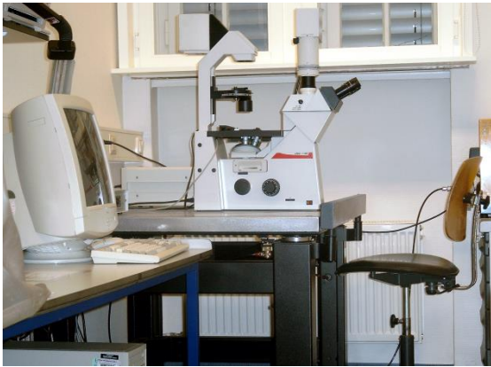
Abbildung 9: Phasenkontrastmikroskop Messplatz zur lichtmikroskopischen Zilienfunktionsmessung.
