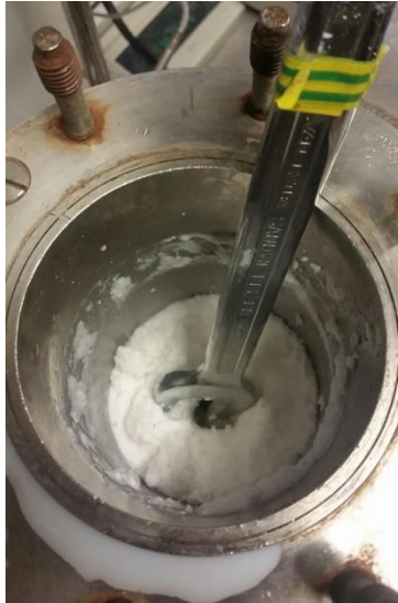
Abb. 5.67. Darstellung einer kollabierten Dispersion nach der Saatpolymerisation mit einem wasserlöslichen Monomer (HEMA).
