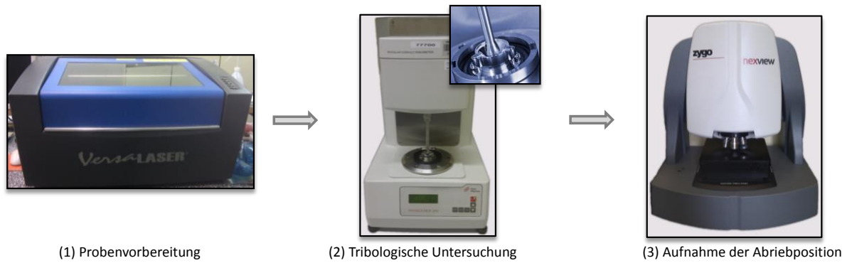
Abb. 6.6. Darstellung des verwendeten Equipements zur Herstellung von Probekörpern (l), zur Messung des Abriebes (m) und zur Untersuchung der Abriebpositionen (r).
