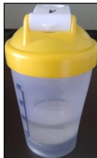
Abb. 6.9. Darstellung des Quellungsbehälters für Langzeitquellungen in Wasser.
