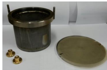
Abb. 6.4. Cobb-DIN-Topf, Deckel, Gummi-Dichtung und Schrauben zum Verschließen.
