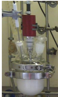
Abb. 5.2. Screening-Anlage zur Herstellung von PVA-Kaolin-Dispersionen.
