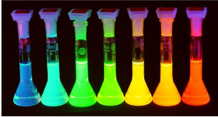
**Abbildung 4.6:** Lösungen von CdSe-Nanokristallen unterschiedlicher Größe unter UV-Licht.<sup>39</sup>
