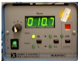
Abbildung 6-11: Mess-/Anzeigergerät IKAVISC.
