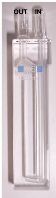
**Abbildung 6-3: Durchflussküvette.**
