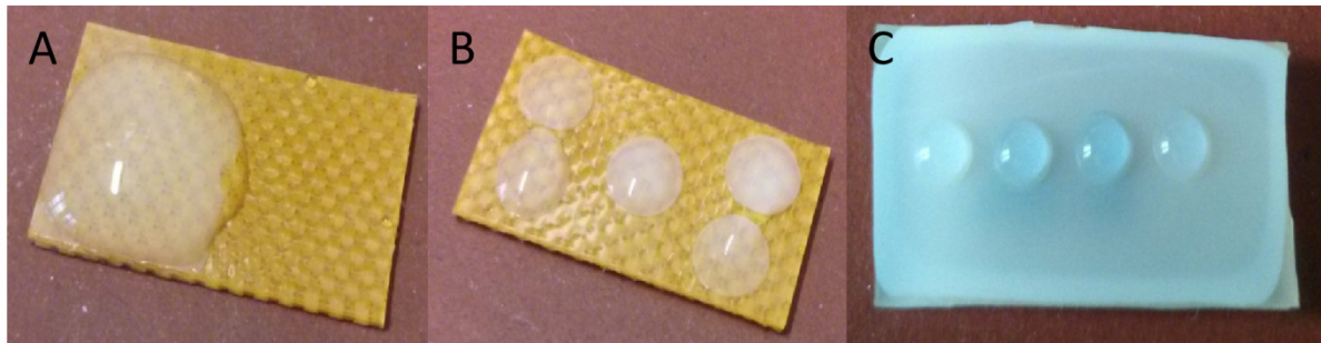
Abbildung 3-7: Plasmamodifikation von PU-M- und PU-P-Trägern mit DADMAC-Lösung (30 Gew.-%). A: Halbseitige Beschichtung mit DADMAC und Benetzung mit Wasser. B: Tropfenweiser Auftrag der DADMAC-Lösung. Die Wassertropfen benetzen ausschließlich die DADMAC-Beschichtung. C: Vollständige DADMAC-Beschichtung auf PU-P. In den Ecken des Trägers ist der deutliche Farbunterschied zwischen unbehandelter PU-P-Oberfläche und hydratisierter DADMAC-Beschichtung sichtbar.
