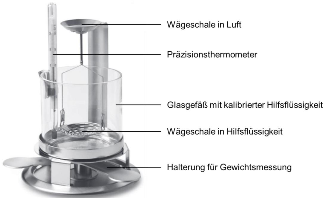
Abb. 3.8: Dichtebestimmungs-Kit der Firma Mettler Toledo zum Einsatz in einer Analysewaage.<sup>[156]</sup>
