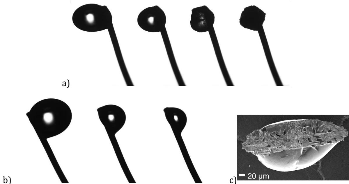
**Abb. 7.13:** a) Ein Mannitoltropfen mit einem Feststoffanteil von 15 % zu Beginn des Experiments mit einer initialen Tropfengröße von 940  $\mu\text{m}$ , der über die Zeit bei 100  $^{\circ}\text{C}$  und 1 % r.H. getrocknet wird. b) Ein Tropfen mit gleichen Feststoffanteil und Temperatur mit einer initialen Tropfengröße von 981  $\mu\text{m}$  und einer r. H. von 15 % und c) der in Abb. b) gezeigte Tropfen am Ende der Trocknung nach dem Quenschen.
