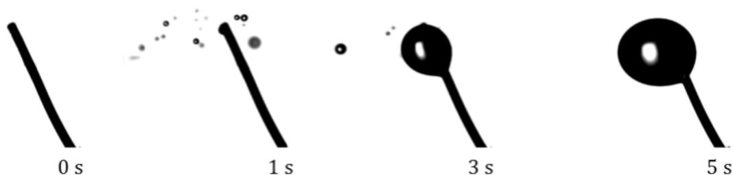
**Abb. 6.5:** Schattenbilder vom Aufbau eines Tropfen an der Spitze des Thermoelement unter Zuhilfenahme des *droplet on demand* Systems. Die Größe des Tropfens beträgt nach fünf Sekunden  $500 \mu\text{m}$ .
