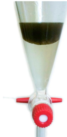
Abbildung 9: (a) Organische und wässrige Phase direkt nach Entleerung des Abscheiders. (b) Trennung der wässrigen und organischen Phase im Scheidetrichter
