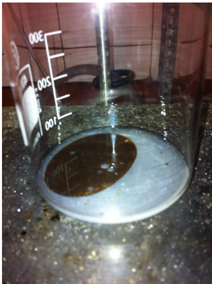
Abbildung 9: (a) Organische und wässrige Phase direkt nach Entleerung des Abscheiders. (b) Trennung der wässrigen und organischen Phase im Scheidetrichter
