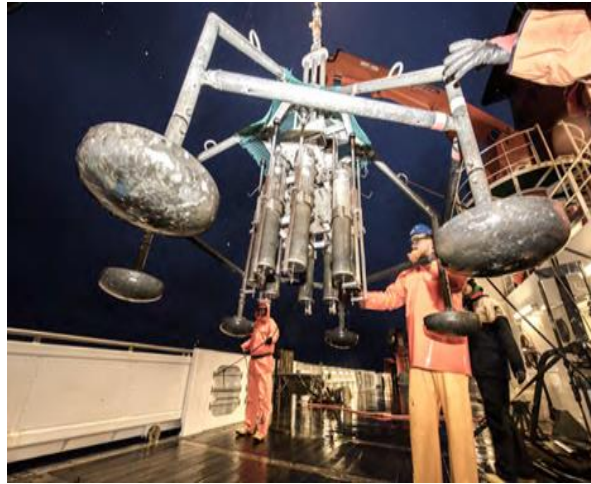
Abbildung 16: Multicorer für die Probenentnahme von Sedimentkernen bis 50 cm an Deck der FS Maria S. Merian (Abschlussbericht MSM50)
