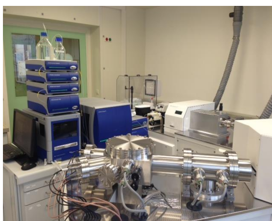
Abbildung 20: Instrumenteller Aufbau der Kopplung zwischen Feldflussfraktionierung und Multikollektor-induktiv-gekoppelter Plasma-Massenspektrometrie
