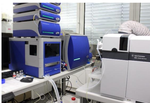
Abbildung 18: Beispielhafter Aufbau der Kopplung zwischen Sedimentations-Feldflussfraktionierung und induktiv gekoppelte Plasma-Tandem Massenspektrometrie
