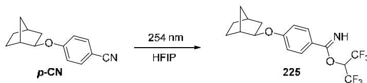
Abbildung 228: Photoreaktion des 4-Cyano-substituierten Norbornyl-Phenylethers p-CN in HFIP; die Bestrahlung mit UV-C-Lampen führt zur Bildung eines Imidats 225 mit dem Lösungsmittel, eine Spaltung der Etherbindung wird nicht beobachtet
