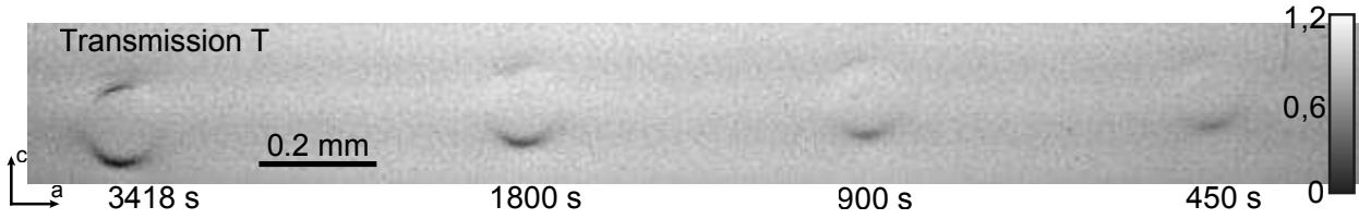
Abbildung 5.22: Transmissionsmikroskopiebild für 4 Belichtungszeiten bei gleicher Beleuchtungsintensität. Die Randeffekte umreißen die beleuchteten Bereiche.
