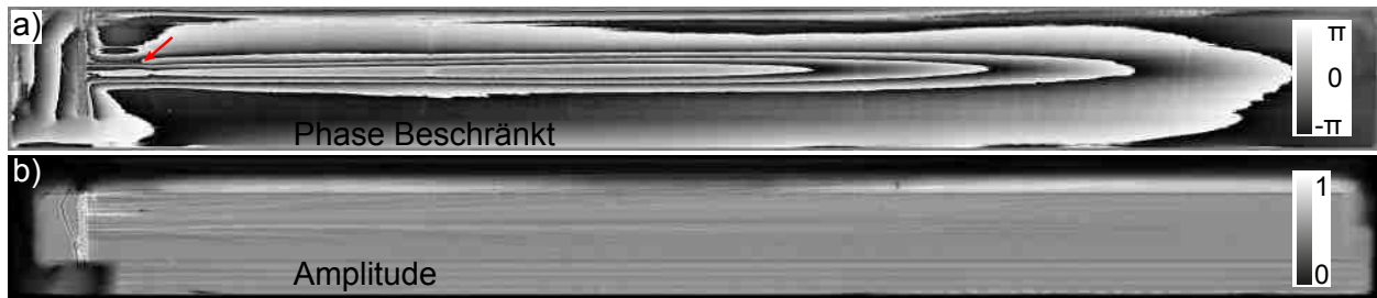
Abbildung 5.27: Rekonstruierter Bereich des Kristalls mit 3,25\ \mu\text{m} großen Pixeln. a) Auf \pm\pi beschränkte Phase der Objektfunktion. Der rote Pfeil zeigt eine unbestimmte Stelle im Phasenbild, ein sogenanntes Residuum. b) Die rekonstruierte Amplitude zeigt starke Artefakte und nur schwache Probeneffekte. Aufgrund dessen wird die Amplitude im folgenden nicht weiter betrachtet.
