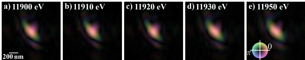
Abbildung 5.8: Für 5 beispielhafte Energien ist das rekonstruierte komplexe Beleuchtungsfeld in der Objektebene dargestellt. Die makroskopische Form und Phasenlage ist bei allen Energien gleich. Durch die Verschiebung der Fokusebenen beim Energiewechsel werden die Seitenbereiche des Primärstahls mit steigender Energie breiter und auch die Nebenmaxima gewinnen leicht an Stärke.
