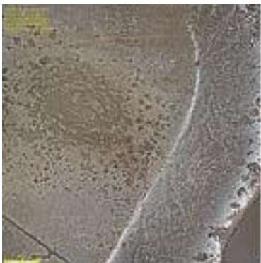
Abb. 10: Typische Defekte der Dentin- Oberfläche nach der Bestrahlung im 45° Winkel und 1mm Abstand und maximalen Druck
