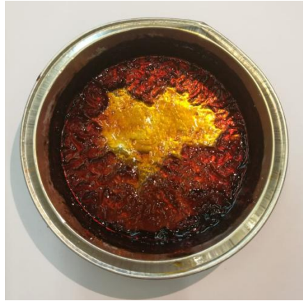
Abb. 6-53: Reaktionsprodukt der thermischen Umsetzung von DMC-OX und PEI.
