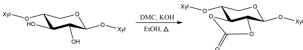
Abb. 6-46: Angestrebte Reaktion für die Herstellung von Xylancarbonaten basierend auf der Publikation von Khiari et al. (2017).
