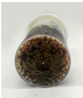
Abb. 6-34: Durch V-601 hergestelltes Gel aus HV-OX (DS 0,89). Durch die Stickstoffbildung im Rahmen der Reaktion kommt es zu einer starken Blasenbildung.
