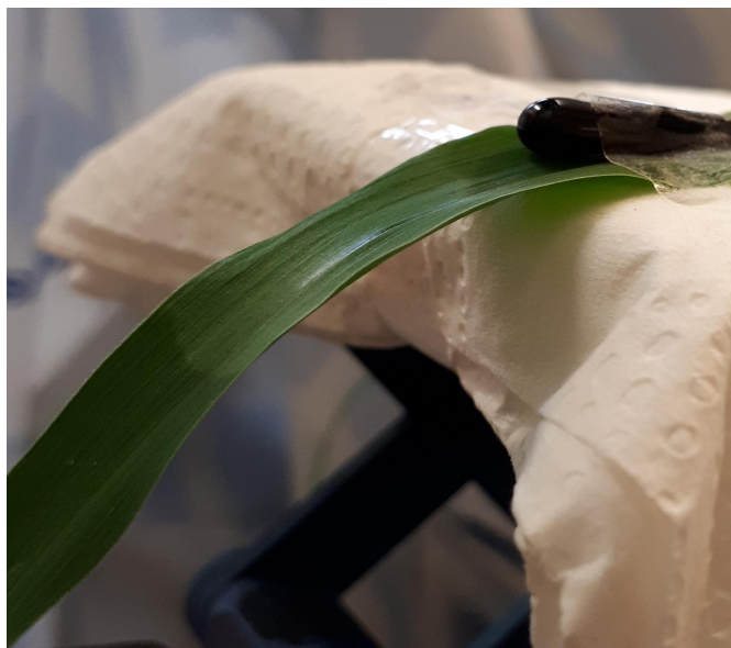
Abbildung 3.4: Beispielhafte Darstellung der Temperaturmessung. Abgebildet ist die Temperaturmessung nach Hitzestimulus in 1 cm Entfernung an einem Zea mays Blatt.
