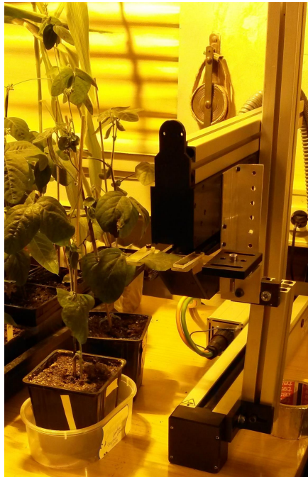
Abbildung 3.8: Transmissionsmessung an Glycine max L. Abgebildet ist die Transmissionsmessung einer trockengestressten Glycine max L. Pflanze mit Terahertzstrahlung (Messort: Philipps-Universität Marburg, Fachbereich: Angewandte Physik AG Koch (Halbleiterphotonik)).
