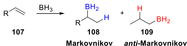
Abb. 74: Hydroborierung von einfachen terminalen Alkenen (Singleton et al. ). [88]
