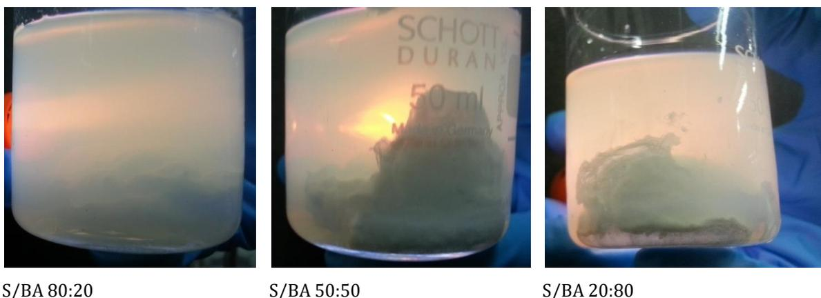
**Abbildung 5.1.13 Copolymervernetzung durch Einführen einer  $\text{CaCl}_2$ -Lösung**
