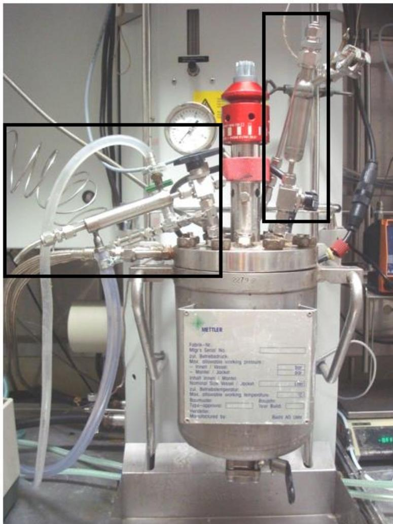
**Abbildung 3.1.5** Speziell angefertigte Nachrüstungen: Das Doppelmantelröhrchen für die Probenahme (im Viereck links) und die Kapsel für die Initiatorzugabe (im Viereck rechts)
