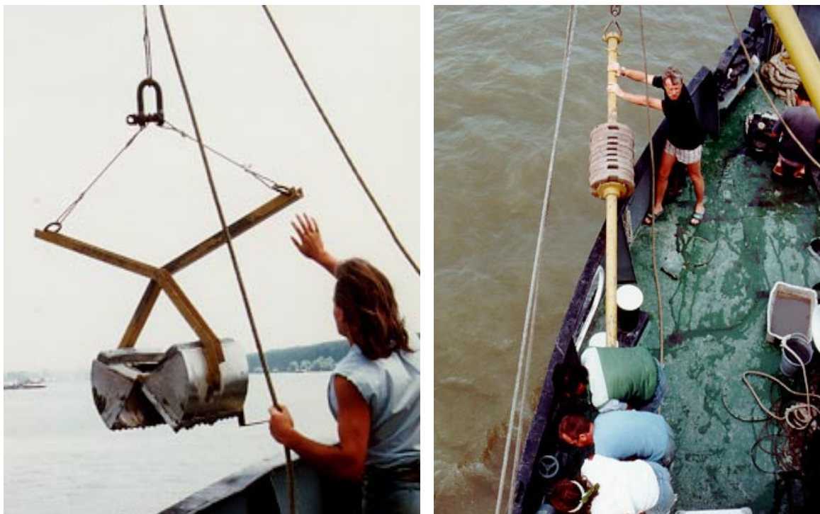
Abb. 13: Links: Backengreifer auf der Donaufahrt. Rechts: Schwerelot auf der Donaufahrt
