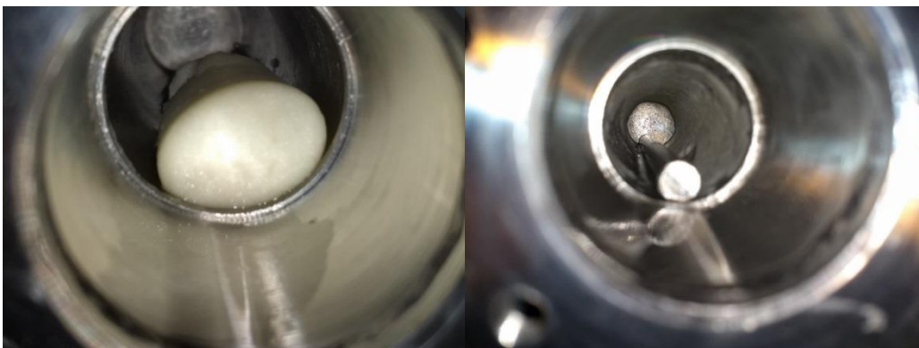
Abb. 59: Alkalicellulose im Stahlreaktor nach 10 minütiger Rotation (58,9 U/min). In der rechten Aufnahme wurde zusammen mit der Reaktionsmasse eine Stahlstange in den Reaktor gegeben.
