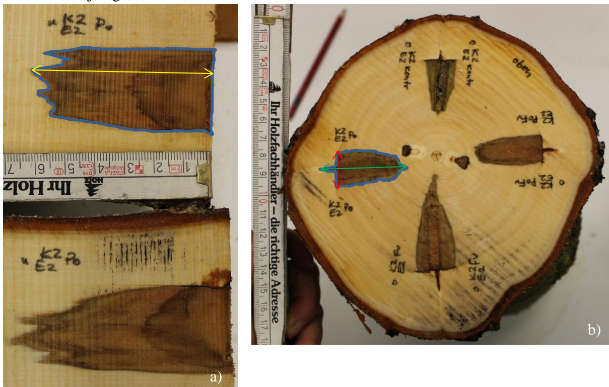
Abbildung 14: Beispiel für axiale (gelber Pfeil (a)), tangentiale (roter Pfeil) und radiale (grüner Pfeil) (b), Verfärbungen in Baum K2. Flächenverfärbungen axial (a) und im Querschnitt blau (b) umrahmt.
