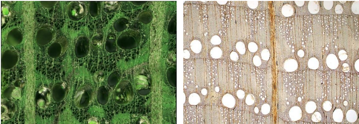
Abb. 2: Das Ergebnis der dreidimensionalen Scannung kann nun am Computer zu einem zweidimensionalen Bild umgewandelt werden. Das nun zur Verfügung stehende Bild (links) hat die gleiche Auflösung bzw. Qualität der Aufnahme einer am klassischen Auflichtmikroskop untersuchten Probe (rechts). Hier am Beispiel von Weiß Eiche ( Quercus spp.).
