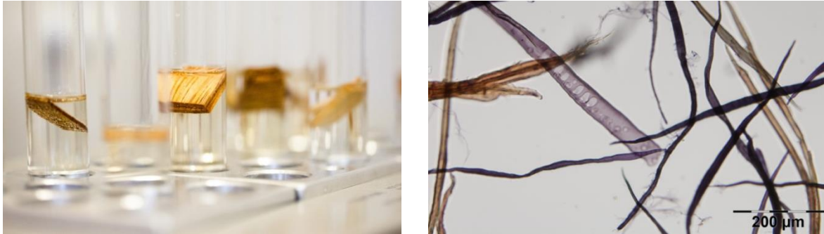
Abb. 3: Herstellung von Mazeraten als Referenzmaterial für die Bestimmung von Hölzern in Faserplatten (links). Mikroskopische Aufnahme von mazerierten Zellelementen (Tracheide und Faserbündel) einer Faserplatte (rechts)
