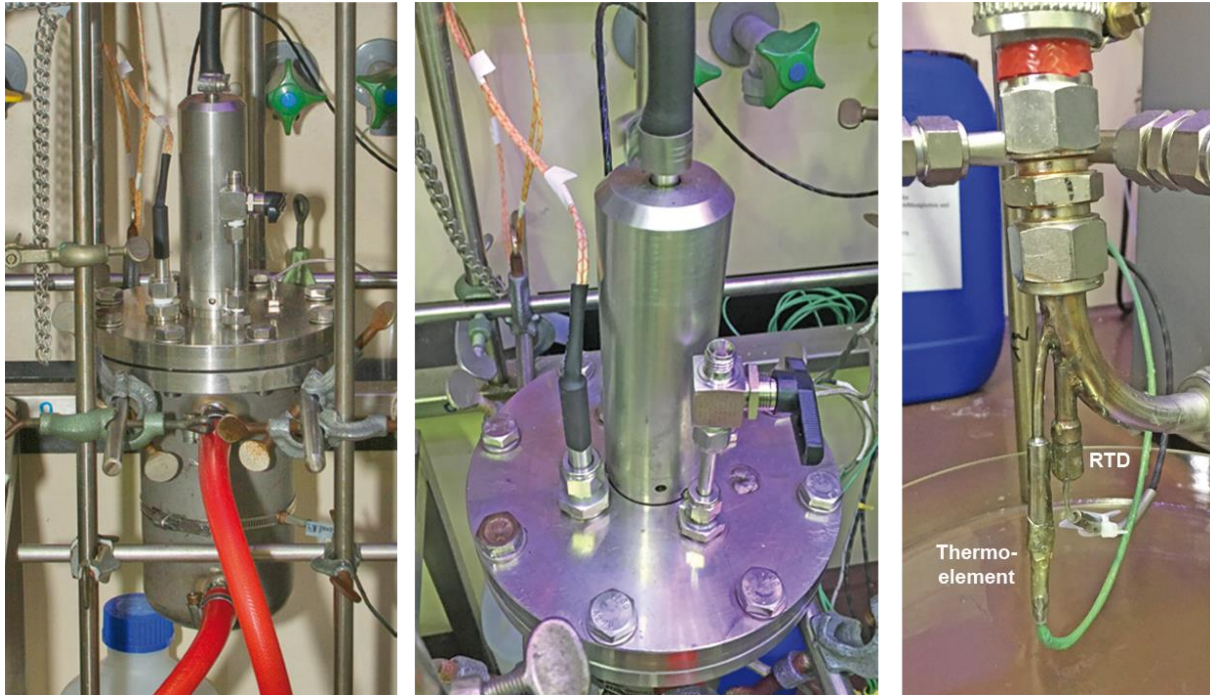
Abb. 51: SIMReakt V1 Draufsicht (links), Reaktordeckel (Mitte), Temperaturmessung am Thermostaten (rechts)
