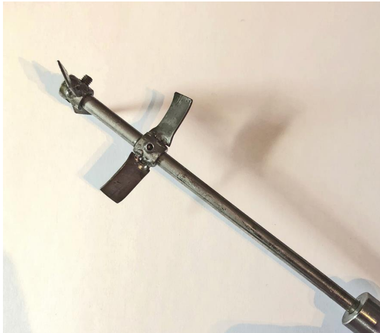
Abb. 57: Zweiblättriger Zentrifugalrührer. Rührblätter mit 5 cm Durchmesser, 90° versetzt
