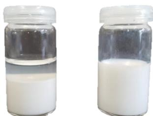
**Abbildung 7.29:** Vergleich einer aggregierten und einer stabilen Dispersion nach Zugabe von NaOH-Lösung ( $1 \text{ mol} \cdot \text{L}^{-1}$ ) bis zu einem pH-Wert von 12. Links: Aggregierte Dispersion hergestellt mit dem ionischen Emulgator SDBS. Rechts: Stabile Dispersion mit dem nicht-ionischen Emulgator Triton X-405.
