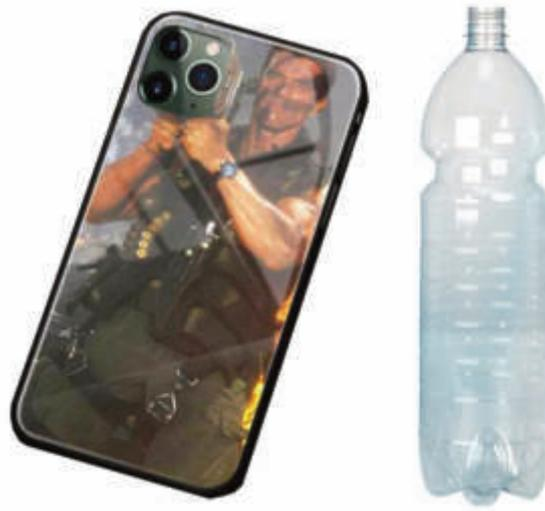
Abbildung 2: Fotografien zweier Polymere in Alltagsgegenständen. ABS-Kunststoff als typisches Gehäusematerial am Beispiel eines Handycovers (links) sowie PET als häufige Umverpackung von Lebensmittelcontainern, hier einer Wasserflasche.
