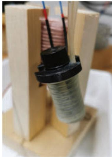
Abbildung 15: Nahaufnahme des bestückten Probenhalters aus ABS mit 4 mL Probengefäß und Kühlschläuchen. Im Hintergrund ist die Spule in Holzhalterung sowie die Temperaturmessfühler (blau-rot-schwarze Kabel) zu erkennen.
