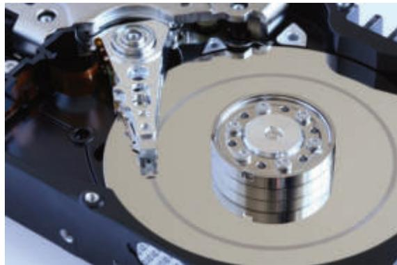
Abbildung 1: Fotografie einer geöffneten 3,5“ Festplatte. Die Datenspeicherung mittels (remanenter) Magnetisierung der Plattenscheiben erfolgt durch den Schreib-Lese-Kopf, indem sich ein Elektromagnet befindet. Die Auslesung der Daten erfolgt über die durch die Remanenzmagnetisierung bewirkte Induktion im Schreib-Lese-Kopf.
