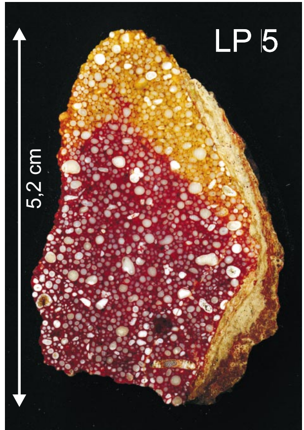
Tafel 5: Anschliffe charakteristisch verkieselter Oolithproben
