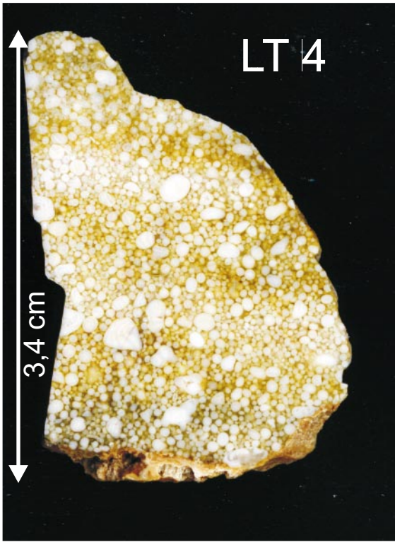
Tafel 5: Anschliffe charakteristisch verkieselter Oolithproben
