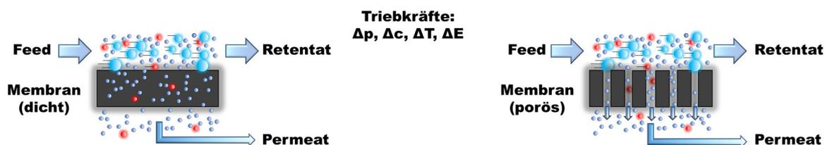
Abb. 2.3. Schematische Darstellung des allgemeinen Ablaufs einer Filtration durch eine Membran. Hier im sogenannten Cross-Flow durch eine dichte Membran (links) bzw. durch eine poröse Membran (rechts). Die nötige Triebkraft ist ein Druck-, Konzentrations- oder Temperaturunterschied oder ein elektrisches Potential.
