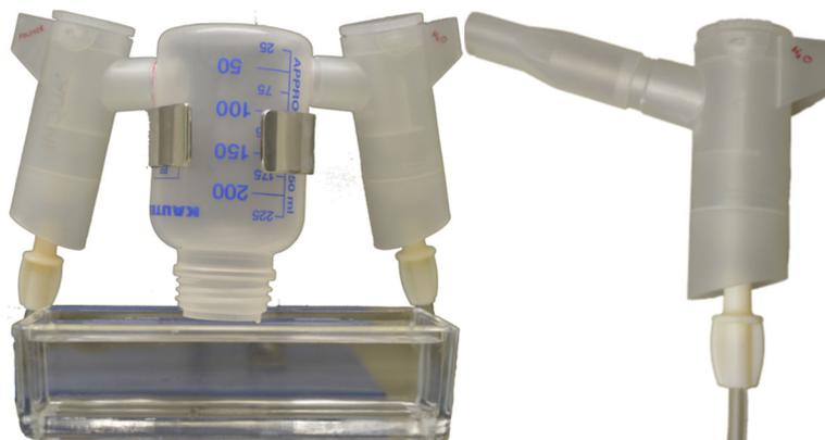
Abb. 8.1. Modifizierter Aerosol-Zerstäuber. Zwei einzelne medizinische Aerosol-Zerstäuber zur Inhalation (rechts) wurden mit einem 200mL PE-Gefäß verbunden, so dass das Aerosolspray senkrecht auf einen Support geleitet wurde.
