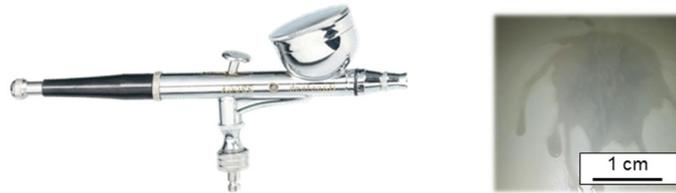
Abb. 4.31. Airbrushpistole (links) mit Abstand  $d_{ns}=10$  cm zum Support. Mit einer Sprühzeit von 10 s wurde eine PS<sub>83</sub>-*b*-P4VP<sub>17</sub><sup>88k</sup>\_DOX<sub>100</sub><sup>1</sup>-Lsg. waagrecht auf einen PAN-Support mit einer Fläche von ca. 3cm<sup>2</sup> gesprüht.
