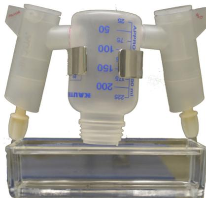
Abb. 8.3. Modifizierte Aerosol-Zerstäuber zur Erzeugung von Polymersphären. Das Aerosol der Polymerlösungen wurde in zwei medizinischen Aerosol-Zerstäubern erzeugt und über eine 250 mL Schraubflasche auf ein Wasserbad geleitet.
