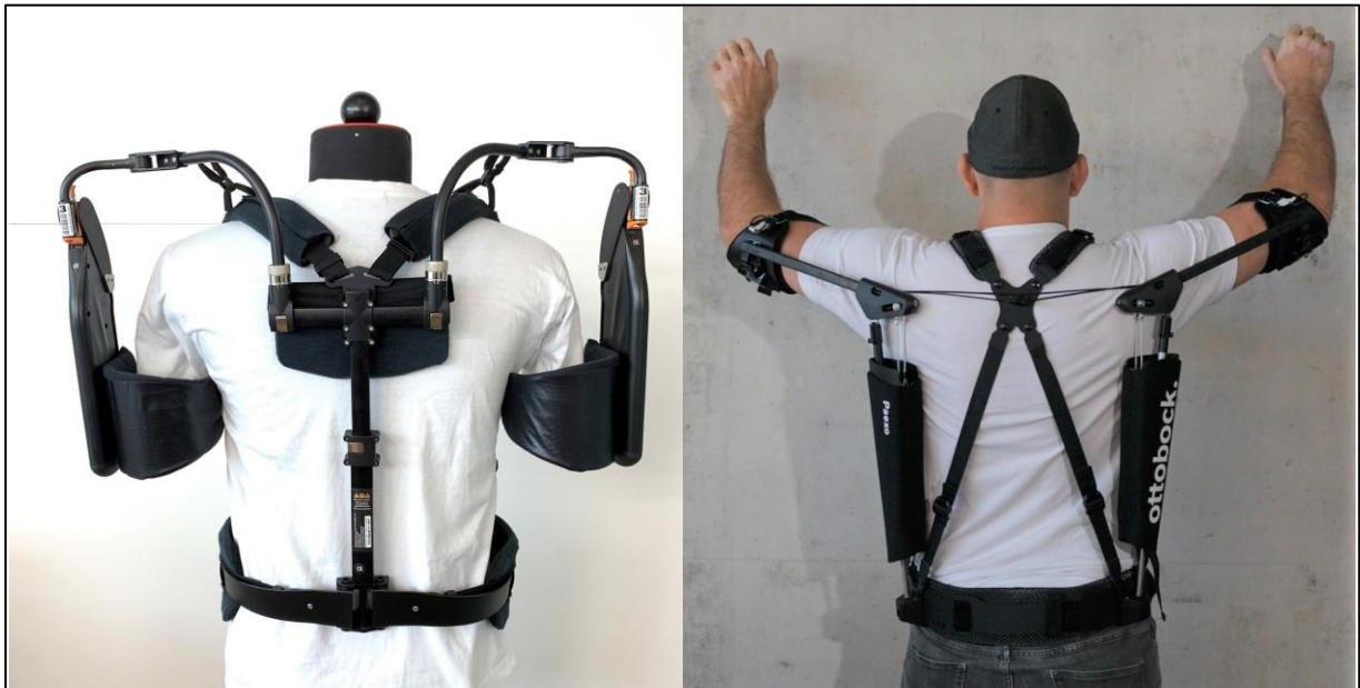
Abb. 9 Exemplarische Darstellung zweier (passiver) industrieller Exoskelette (Levitate Airframe (links) und Paexo (rechts))
