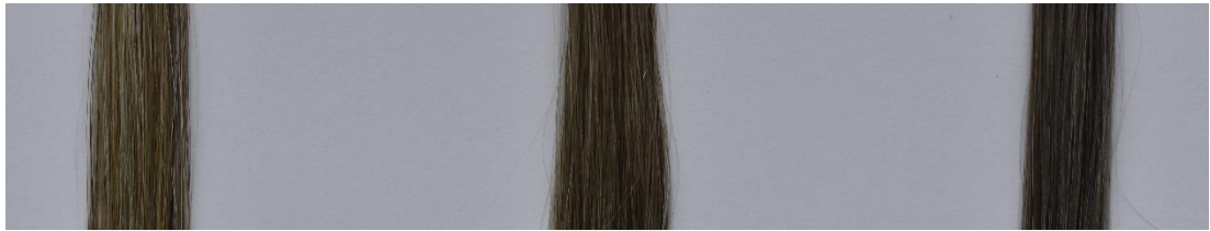
Abb. 21 Haartresse von links nach rechts, unbehandelt, erst mit Eisen(II)-laktat dann mit Mimosa behandelt, erst mit Mimosa dann mit Eisen(II)-laktat behandelt.
