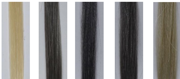
Abb. 34 Screening diverser Eisensalze von links nach rechts: Haartressen behandelt mit Matcha, mit Matcha und Eisen(II)-laktat, mit Matcha und Eisen(II)-glukonat, mit Matcha und Eisen(II)-sulfat, mit Matcha und Eisen(III)-sulfat.
